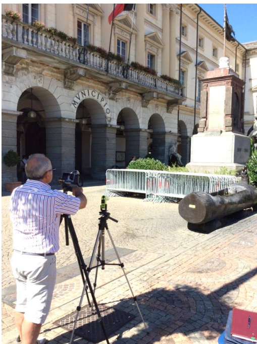
Foto 7 , 10 Luglio 2015, Aut. S. B., Lato Est. Stazione S1: distanza m 14,5 – fase di rilievo termografico
